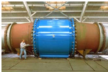
生产世界上最大规格的电磁流量计（直径3米）
